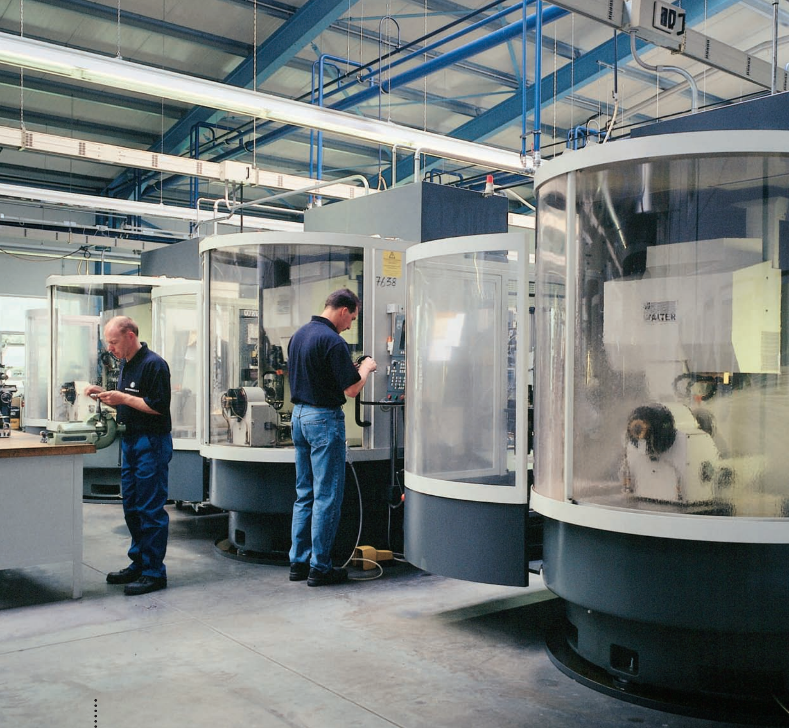
Moderne Fünfachs-Schleifzentren für die Komplettbearbeitung schwierigster Werkzeuge. State-of-the-art five-axis grinding centres for the production of complicated tools in one set-up.
